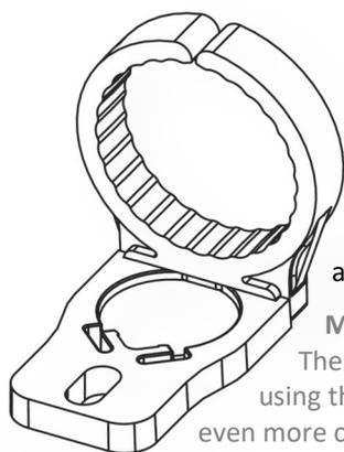
**Befestigungsclips** mit starkem Magnet und Langloch für Schraubmontage. In den Clips kann die Leuchte in mehreren Stufen um 90° in jede Richtung geschwenkt werden. Bei Verwendung der Magnetbefestigung können die Clips für eine kompaktere Montage auch um 180° nach innen gedreht angebracht werden.
